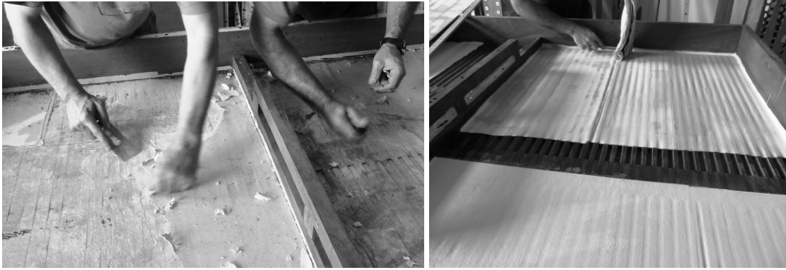
Fig. 10 – Retirada das peles antigas e colocação de novas peles no someiro.
