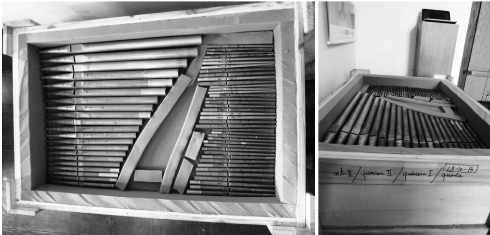
Fig. 6 – Tubos históricos já restaurados reacondicionados em suas caixas correspondentes à espera da montagem do instrumento.
