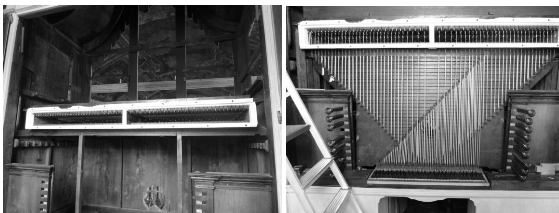
Fig. 14 – Recolocação do someiro e das mecânicas de registro e notas na caixa do órgão.
